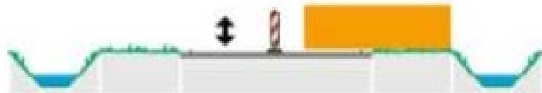
Situatie 3 – werken vanaf of op de rijbaan
