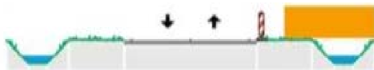
Situatie 1 – werken naast de rijbaan
