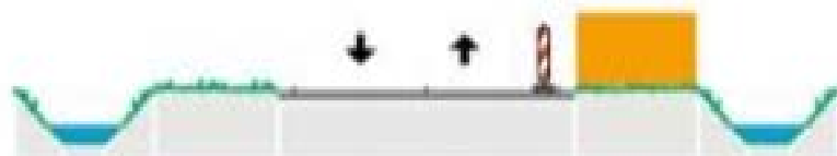
Situatie 2 – werken direct naast de rijbaan
